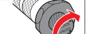
締めつけトルク設定完了後、ロックつまみを時計方向に止まるまで回して、グリップをロックしてください。
