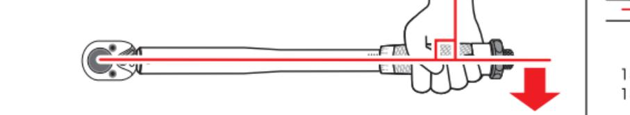
2. 設定したトルク値になると「カチッ」という音と共に、手に軽い衝撃が伝わりボルト、ナットが設定したトルク値で締めつけられたことをお知らせします。<注意>音が鳴った後も締め続けると締めすぎの状態になります。音が鳴った時点で締めつけをやめてください。
