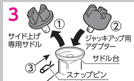
3 サドル台からサイド上げ専用サドルを取りはずし、ジャッキアップ用アダプターを取り付けてください。
