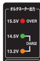
オルタネーターの出力電圧が高すぎます。オルタネーターを点検してください。
