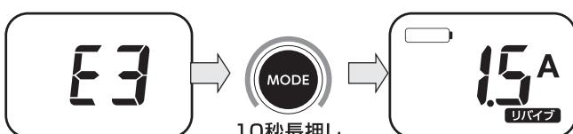
※重要 リン酸鉄リチウムイオンバッテリー(LiFePO4)にリバイブモードは絶対に使用しないでください。
