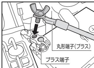
5. バッテリー接続コードの丸形端子マイナス(黒)を自動車のバッテリーのプラス端子に接続してください。
