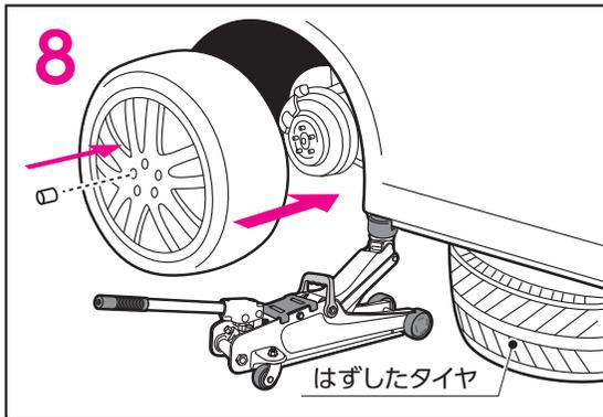
8 交換用タイヤを取り付け、ホイールナットを手で回して取り付けた後に、クロスレンチなどを用いて仮締めし、車両の下に敷いたタイヤを取り出してください。
