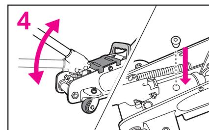
4 ハンドルをハンドルスリーブに差し込み、すばやく10回程度上下にポンピングしてください。リフティングアームが最上位まで上がることを確認したのちオイルプラグを取り付けてカバーを元の状態に戻してください。
