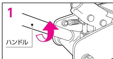
1 ジャッキを水平な場所へ置き、カバーをはずしてリリースバルブをゆるめてください。
