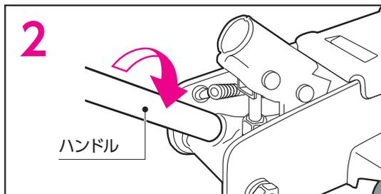
2 ハンドルの先端をリリースバルブに差し込み、ハンドルを両手で持ち、時計回りに確実に締め付けてください。
