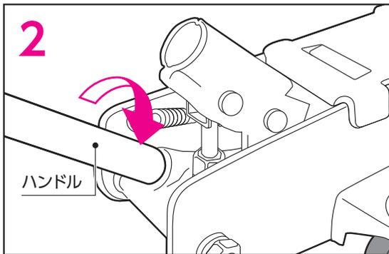
2 ハンドルの先端をリリースバルブに差し込み、ハンドルを両手で持ち、時計回りに確実に締め付けてください。
