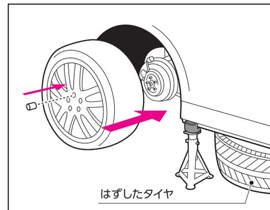
11 交換用タイヤを取り付け、ホイールナットを手で回して取り付け後、クロスレンチなどを用いて仮締めし、車両の下に敷いたタイヤを取り出してください。
