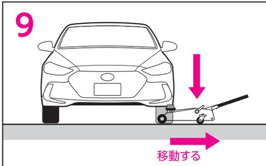
9 作業後、リリースバルブを反時計回りにゆっくり回しジャッキダウンしてください。
