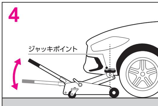
4 ハンドルをハンドルスリーブに差し込みハンドル先端のロックピンを正しくセットしてください。ハンドルを上下に動かしジャッキポイント付近まで上昇させ一度停止し、荷重の中心がサドルの中央にかかることを確認してください。
