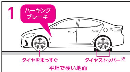
1 平坦で硬い地面に車両を停車し、パーキングブレーキを確実にかけ、左図を参照にタイヤストッパー (輪止め) 【別売】“P14 関連商品 参照”をセットしてください。
