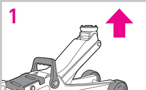
1 リリースバルブを締め、サドルを固定しているスナップピンが見える位置までリフティングアームを上昇させてください。
