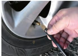
タイヤのエアバルブにコンプレッサーのバルブをねじ込む。しっかりと最後までねじ込まないと空気漏れを起こすので注意。
