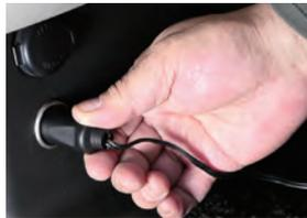
電源プラグをアクセサリソケットに差し込む。ケーブル長は約3.3m。左右のドアから引き出せば、4輪すべてに届くはず。
