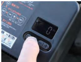
充填圧力をセットした後、電源ボタンを押すと充填開始、設定した圧力になると自動で停止する。
