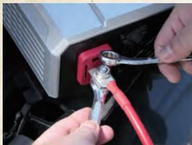
DC/ACインバーターにワンタッチ電源接続コードを取り付ける。その際にはスパナなどの工具が必要だ。
