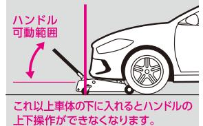
4 ハンドルをハンドルスリーブに差し込みハンドル先端のロックピンを正しくセットしてください。ハンドルを上下に動かしジャッキポイント付近まで上昇させ一度停止し、荷重の中心がサドルの中央にかかることを確認してください。
