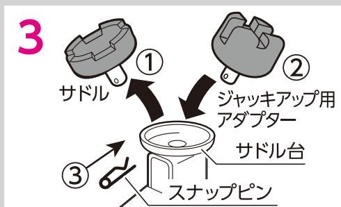
2 サドルを固定しているスナップピンをプライヤなどの工具で取りはずしてください。
