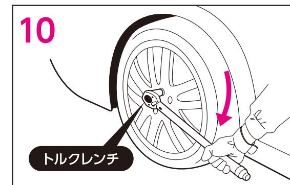
10 ジャッキを安全なところまで移動させて、トルクレンチ【別売】“P14 関連商品 参照”を使用し、規定のトルク値でホイールナットを本締めしてください。
