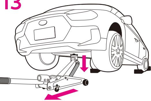
13 車両の下に入れているジャッキスタンドをはずし、リリースバルブを反時計回りにゆっくり回しジャッキダウンしてください。
