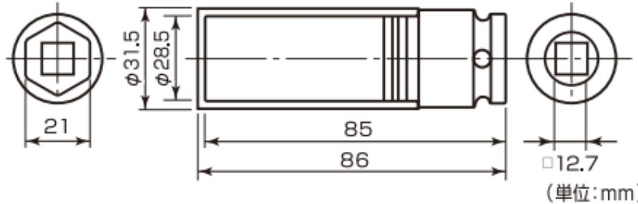
材 質：クロムモリブデン鋼、プラスチック（プロテクター）
