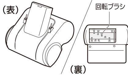
本体の吸入口に取り付けることによって、自動回転ブラシに内蔵されたモーターで回転ブラシを回して、ゴミをかき出し、効率よくお掃除ができます。
