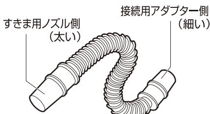
接続用アダプターとすきま用ノズルの間に取り付けると狭い場所のゴミを吸ったり、吹き飛ばすことが、より簡単にできます。
