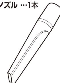
接続用アダプターを使用して本体の吸入口または吹出口に取り付けることができます。また、延長用ホースにも取り付けることができます。
