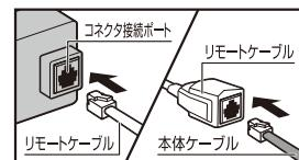
●操作パネルのコネクタ接続ポートに、リモートケーブルのコネクタを差し込んでください。
