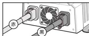
5. 製品側の接続を完了・確認してから、反対側の丸型端子を + 端子へ、 - 端子へ順にバッテリーに接続します。
