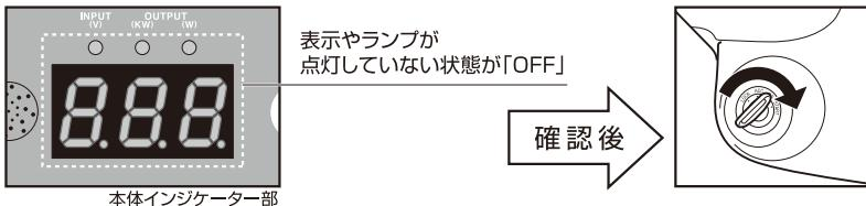
3. 本製品の電源スイッチを押して「ON」の状態にしてください。インジケーターが点灯し現在の入力電圧と消費電力を交互に表示します。
