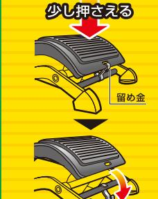
※留め金を外す足踏みペダルが上に跳ね上がります。留め金を外す際にはペダル部分に手を添えて外してください。
