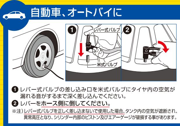
※注) 取り外しの際は、使用方法の逆の操作をして取り外してください。
