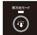
バッテリー端子電圧を自動認識した後、充電電圧モードランプが点灯します。12V/24Vのどちらかのランプが点灯した後すぐに寒冷地/ドライセルモード選択ボタンを押してください。
