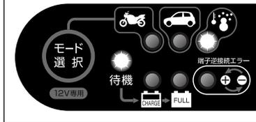
軽自動車モードと同じ条件で、低温時(約10℃以下)や充電するバッテリーの種類がドライセルバッテリーの場合、このモードを選択してください。
