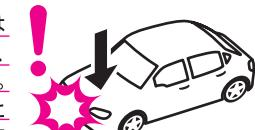
10 ジャッキを安全なところまで移動させて、トルクレンチ【別売】“P14 関連商品 参照”を使用し、規定のトルク値でホイールナットを本締めしてください。
