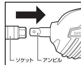
6. ホイールに対して、直角になるようにソケットを奥までしっかりと差し込み、スイッチの「L」側を引くと、モーターが回転を始め、約1~2秒の空転の後「ガチン」とインパクト音がなります。
