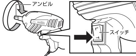
△注意：5回以上インパクトを続けると締まり過ぎたり、場合によってはハブボルトが折れる恐れがあります。ラグナットの締めすぎに充分注意してください。また、17mmのソケットでラグナットを締め過ぎるとソケットやハブボルトが破損する恐れがあります。
