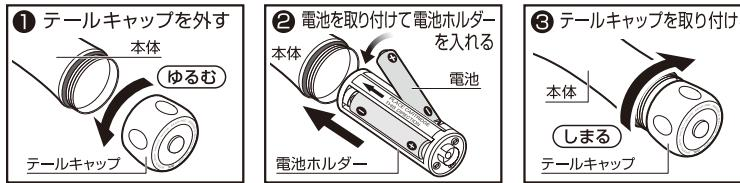
上図①～③の手順に従って本体に電池ホルダーをセットしてください。
