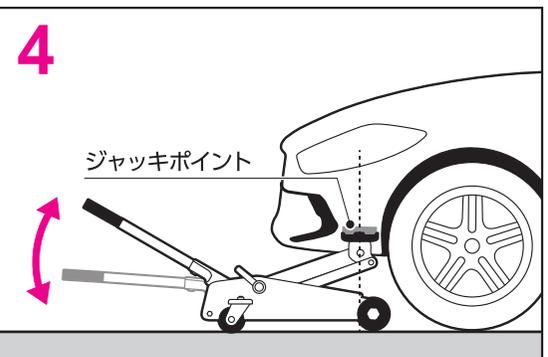
4 ハンドルをハンドルスリーブに差し込みハンドル先端のロックピンを正しくセットしてください。ハンドルを上下に動かしジャッキポイント付近まで上昇させ一度停止し、荷重の中心がサドルの中央にかかることを確認してください。
