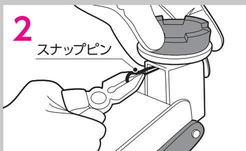
2 サドルを固定しているスナップピンをプライヤーなどの工具で取りはずしてください。
