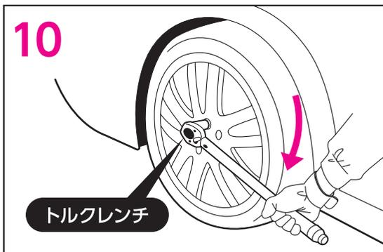
10 ジャッキを安全なところまで移動させて、トルクレンチ【別売】“P14 関連商品 参照”を使用し、規定のトルク値でホイールナットを本締めしてください。
