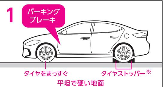
1 平坦で硬い地面に車両を停車し、パーキングブレーキを確実にかけ、左図を参照にタイヤストッパー (輪止め) 【別売】“P14 関連商品 参照”をセットしてください。
