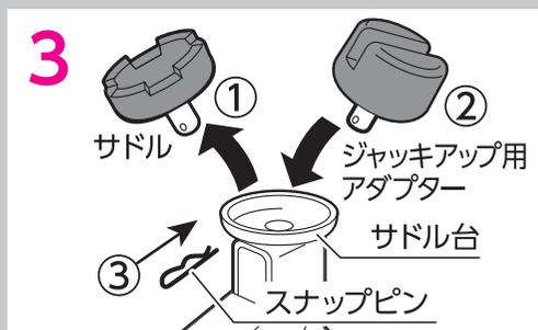
3 サドル台からサドルを取りはずし、ジャッキアップ用アダプターを取り付けてください。次にジャッキアップ用アダプターにスナップピンを差し込んでください。
