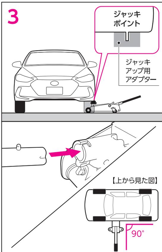
3 ハンドルをハンドルスリーブに差し込み、ジャッキを車両のサイド上げ用のジャッキポイントの下まで入れてください。ジャッキアップ用アダプターがジャッキポイントに軽く接触するまでハンドルを上下に動かしサドルを上げてください。
