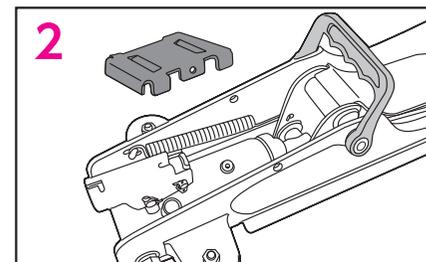
2 カバーを固定しているボルトを取りはずし、カバーを取りはずしてください。オイルプラグをプライヤーなどの工具ではずしてください。
