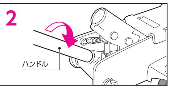
2 ハンドルの先端をリリースバルブに差し込み、ハンドルを両手で持ち、時計回りに確実に締め付けてください。
