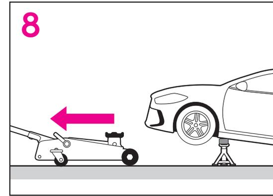
8 ジャッキスタンドが、車両を完全に支えていることを確認し、ジャッキのサドルを下げ、安全なところまで、車両から離してください。
