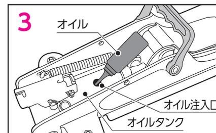
3 オイル量を確認します。オイル注入口から油面まで約3mm以上の空間がある場合は適量までジャッキ専用作動油【別売】“P14 関連商品 参照”を注油してください。
