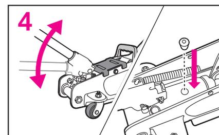
4 ハンドルをハンドルスリーブに差し込み、すばやく10回程度上下にポンピングしてください。リフティングアームが最上位まで上がることを確認したのちオイルプラグを取り付けてカバーを元の状態に戻してください。
