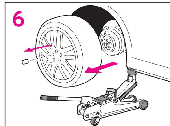
6 タイヤが浮くまで上昇させ、クロスレンチなどでホイールナットをはずし、タイヤをはずしてください。
