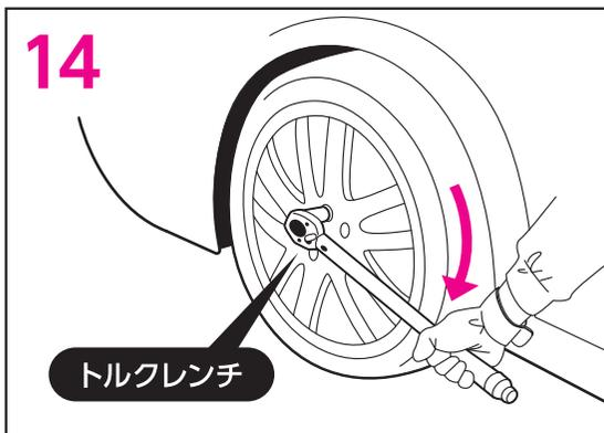
14 ジャッキを安全なところまで移動させて、トルクレンチ【別売】“P14 関連商品 参照”を使用し、規定のトルク値でホイールナットを本締めしてください。
