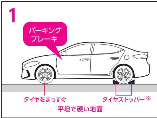
1 平坦で硬い地面に車両を停車し、パーキングブレーキを確実にかけ、左図を参照にタイヤストッパー（輪止め）【別売】“P14 関連商品 参照”をセットしてください。
