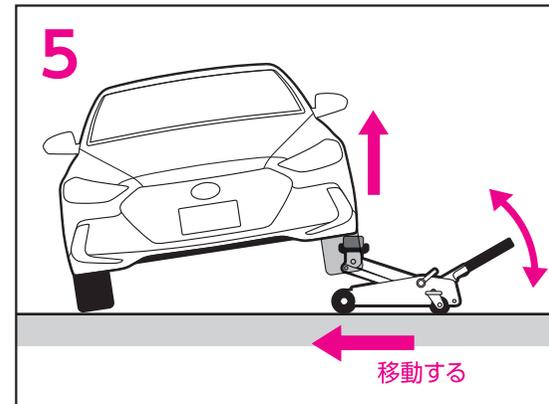
5 ジャッキアップ用アダプターがサイド上げ用のジャッキポイントに確実に接触しているか確認後、ハンドルを上下に動かしジャッキアップする。ジャッキアップに伴い本製品が矢印の方向に移動しているか確認しながら作業を行ってください。
