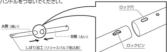
3) ハンドルのA側のしおりをリリースバルブに差し込み、時計方向に回してリリースバルブを締めます。※リリースバルブの締付けが不十分な場合、ジャッキアップしなかったり、下がってきたりしますのでしっかりと締めてください。
