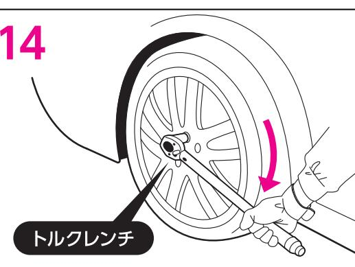
14 ジャッキを安全なところまで移動させて、トルクレンチ【別売】“P14 関連商品 参照”を使用し、規定のトルク値でホイールナットを本締めしてください。
