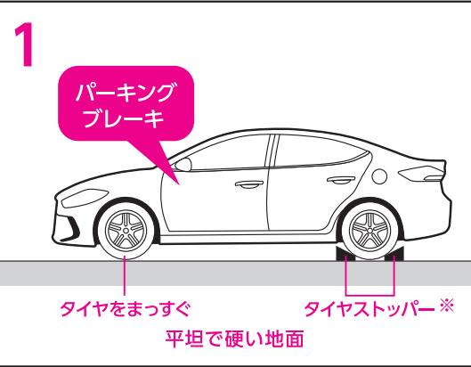
1 平坦で硬い地面に車両を停車し、パーキングブレーキを確実にかけ、左図を参照にタイヤストッパー(輪止め)【別売】“P14 関連商品 参照”をセットしてください。
