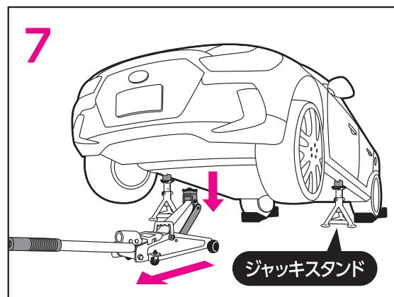
7 ジャッキスタンドを、車両のジャッキポイントの真下になるように合わせて置き、ジャッキスタンドが車両を維持するまでリリースバルブを反時計回りにゆっくり回し、ジャッキダウンします。
