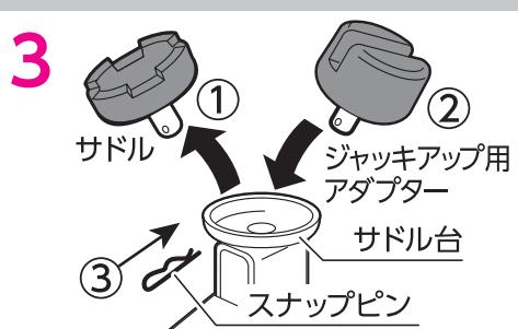
1 リリースバルブを締め、サドルを固定しているスナップピンが見える位置までリフティングアームを上昇させてください。
