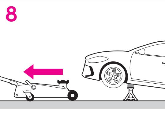
8 ジャッキスタンドが、車両を完全に支えていることを確認し、ジャッキのサドルを下げて安全なところまで、車両から離してください。
