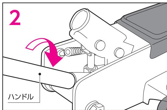
2 ハンドルの先端をリリースバルブに差し込み、ハンドルを両手で持ち、時計回りに確実に締め付けてください。
