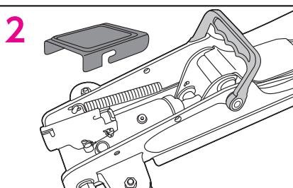
2 カバーを固定しているボルトを取りはずし、カバーを取りはずしてください。
