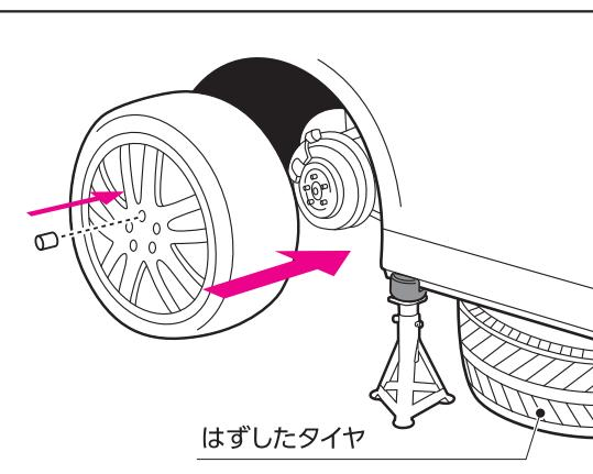
11 交換用タイヤを取り付け、ホイールナットを手で回して取り付け後、クロスレンチなどを用いて仮締めし、車両の下に敷いたタイヤを取り出してください。
