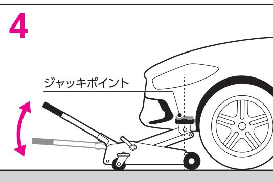
4 ハンドルをハンドルスリーブに差し込みハンドル先端のロックピンを正しくセットしてください。ハンドルを上下に動かしジャッキポイント付近まで上昇させ一度停止し、荷重の中心がサドルの中央にかかるのを確認してください。
