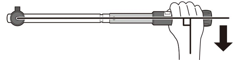
2 設定したトルク値になると「カチッ」という音と共に手に軽い衝撃が伝わり、ボルト・ナットが設定したトルク値で締め付けられたことをお知らせします。“右図参照”
