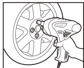
7. そのままスイッチを引き続けると、再びモーターが回転を始め、上記6.と同様に空転の後インパクトが発生します。3~4回のインパクトでラグナットが緩みます。
