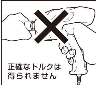
2. 本製品のインパクト発生は遠心クラッチ方式です。モーターの回転にて遠心力を得るため、約1~2秒間空転し、モーターの回転が充分になつた時にインパクトが行なわれ、トルクが得られます。エアー式のインパクトレンチのように、スイッチを引いてすぐにインパクトが発生する機構ではありませんのでご注意ください。
