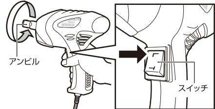
5. 車両のラグナットに適合したソケットを選択し、本体先端のアンビルにしっかりと差し込んでください。
