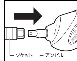
6. ホイールに対して、直角になるようにソケットを奥までしっかりと差し込み、スイッチの「L」側を引くと、モーターが回転を始め、約1~2秒の空転の後「ガチン」とインパクト音がなります。
