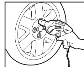
7. そのままスイッチを引き続けると、再びモーターが回転を始め、上記6.と同様に空転の後インパクトが発生します。3~4回のインパクトでラグナットが緩みます。
