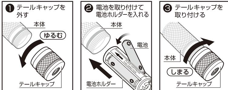
上図①～③の手順に従って本体に電池ホルダーをセットしてください。
