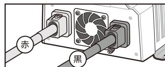
5. 製品側の接続を完了・確認してから、反対側の丸型端子を①端子、②端子の順にバッテリーに接続します。
