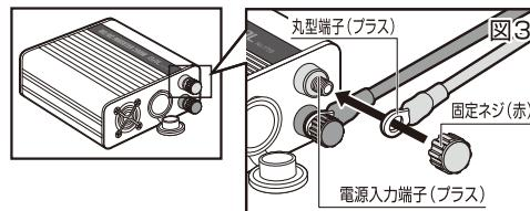
**警告** 電源入力コードは固定ネジで確実に固定してください。ボルトに緩みがあった場合、火花が飛び火災等の原因となります。
