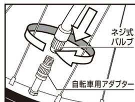
2) ネジ式バルブを時計方向に回して自転車用アダプターに取り付けてください。
